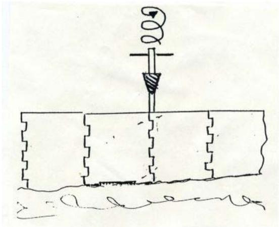
**Zum Ausbessern und Demontieren sind die Elemente mit dem Spezialausziehdrill (siehe Angebot) leicht zu trennen.**
